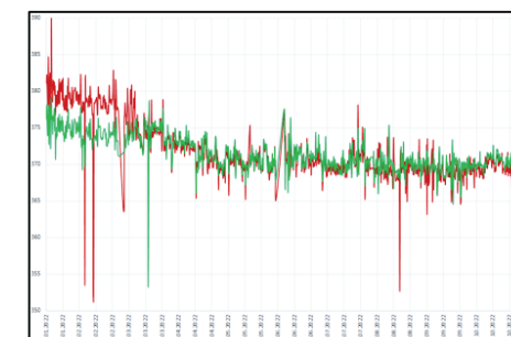
Температура потоков нефти из печи II-1 с внедрением СУУТП
