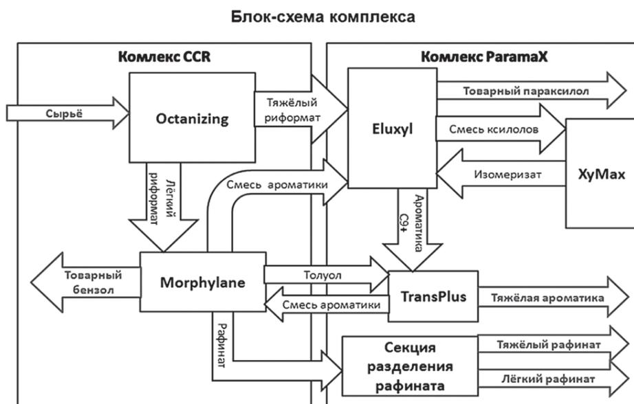
При этом, выбранная схема обеспечивает возможность эксплуатации КПА в 2-х режимах: топливный и нефтехимический. При топливном режиме возможно производить высокооктановые компоненты товарных бензинов, а нефтехимический является базовым вариантом с производством ароматики. Какой из вариантов наиболее предпочтителен, при вводе в эксплуатацию и последующей работе КПА, будет определяться из конъюнктуры рынка потребления моторных топлив.
