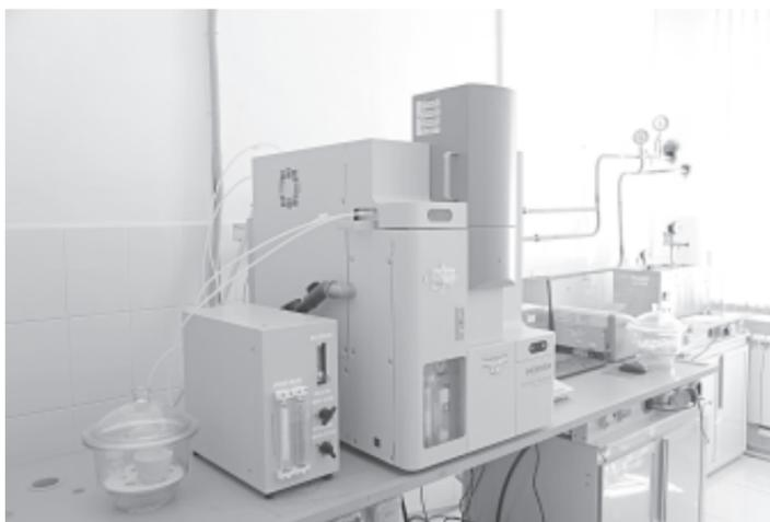
Анализатор определения серы и углерода в катализаторах
